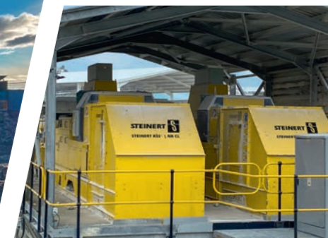
STEINERT KSS | NR CL Pre-concentración de Dolomita blanca
